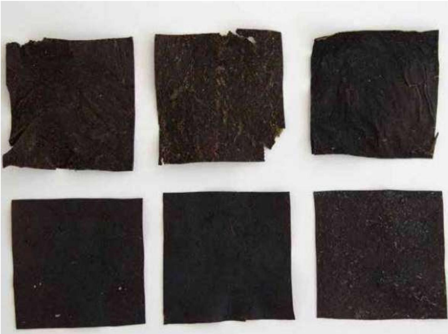
« Le Banane Lab est un projet d'expérimentations à la création d'une gamme de matériaux à base de peaux de banane. Selon le processus de transformation qui lui est appliqué, un matériau similaire à du « cuir » peut être obtenu. J'ai ainsi créé une gamme d'échantillons pour présenter mes recherches matérielles ».
